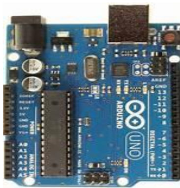
Figure 1: Arduino Uno (Banzi, M., & Shiloh, M).
